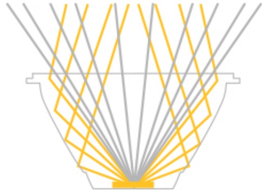
Lichtverspilling van traditionele Reflector
