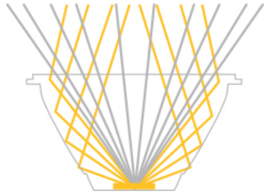
Lichtverspilling van traditionele Reflector
